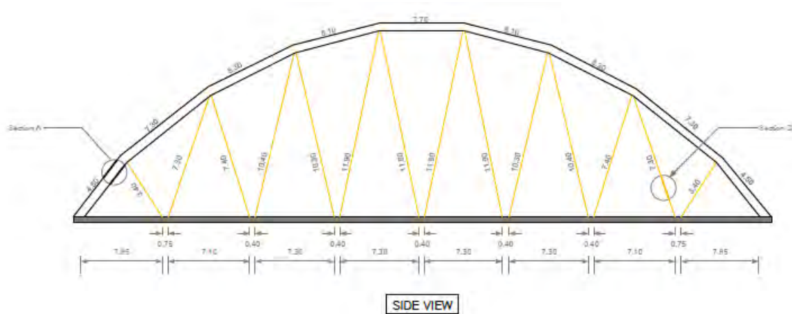
รูปที่ 8-2 โครงสร้าง Tied-arch ก่อนการเสริมกำลัง
